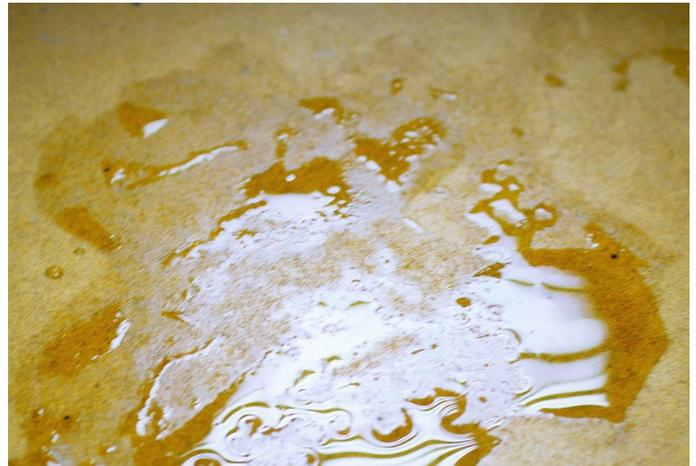
Si la goutte d'eau est absorbée en moins de 10 secondes, le support est dit poreux. Au-delà, le support est dit fermé.
