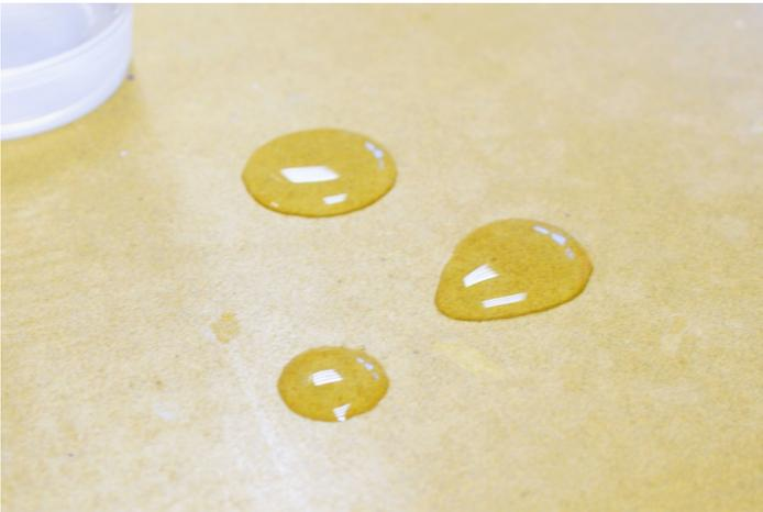
En cas de doute sur la porosité du support, faire le test de la goutte d'eau en versant quelques gouttes d'eau sur le support.
