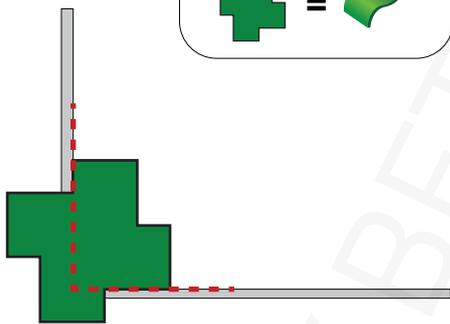
Aligner la matrice flexible sur le bord du coffrage comme sur le schéma.
